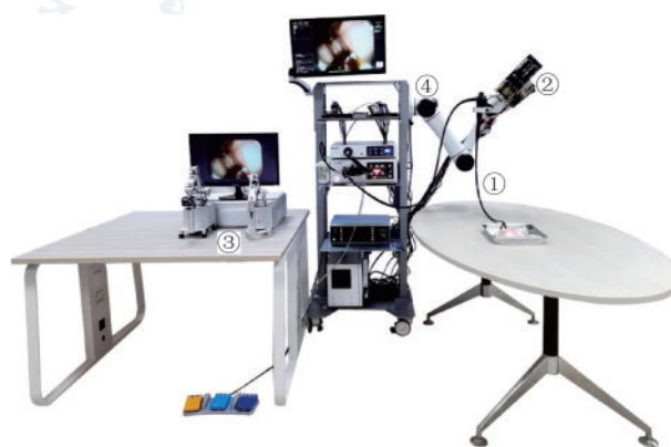
注:①为柔性双通道内镜;②为柔性手术执行器;③为操作主手;④为六自由度定位臂
