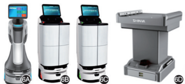
图6 新型内镜中心智能转运系统硬件组成部分 6A:智能导引机器人;6B:内镜回收机器人;6C:内镜发放机器人;6D:自动对接机器人
